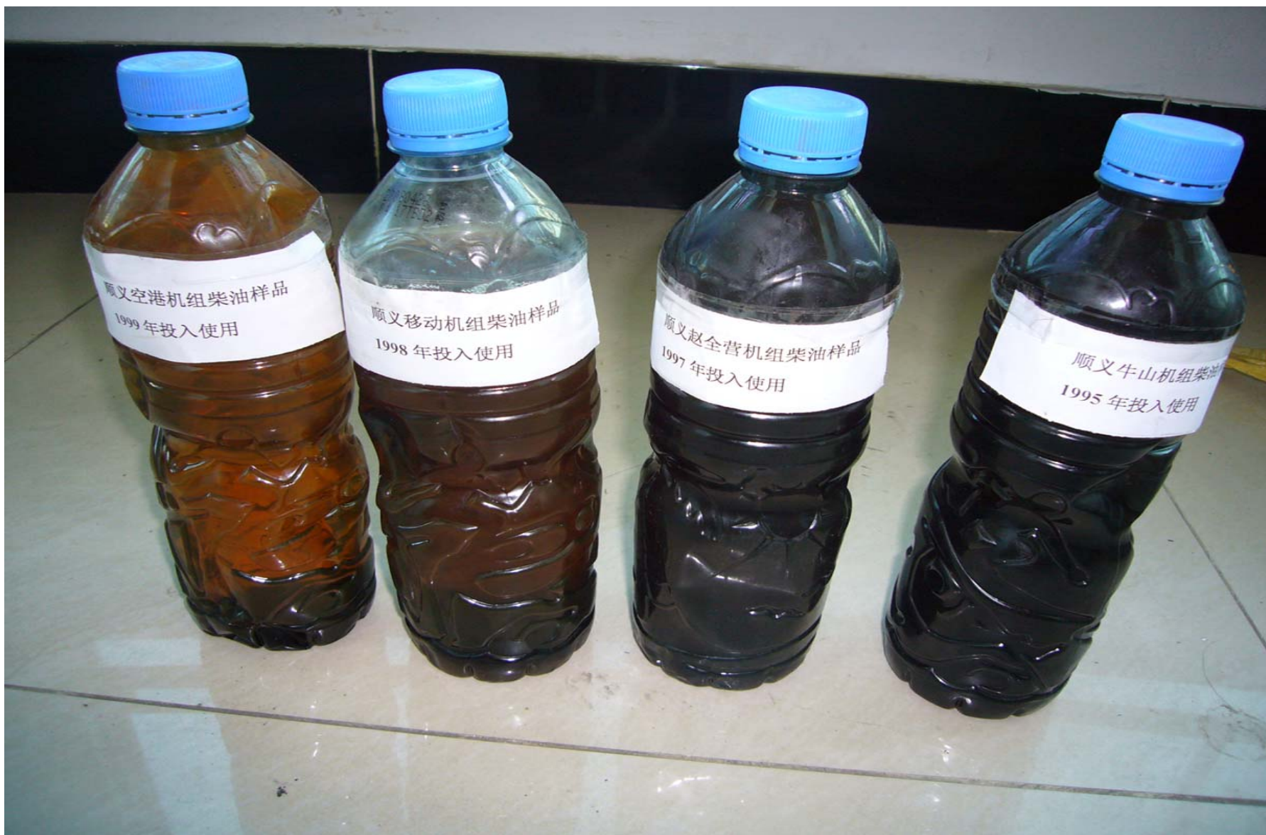
上图为所取样品沉淀 1 个月以后的颜色。对于超过 10 年以上的底座油箱柴油与污物靠沉淀分离不出来。
